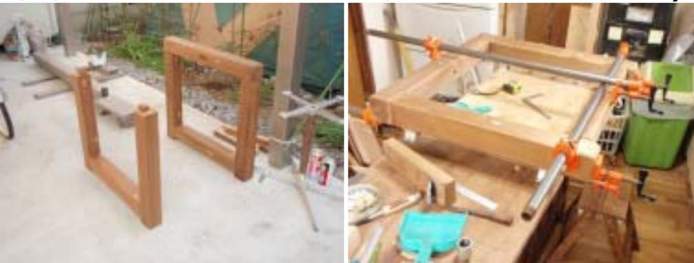
脚材はサーモウツの角材。松系の材を熱処理したもので、ウッドデッキ等に使用され、丈夫で耐久性もある。
