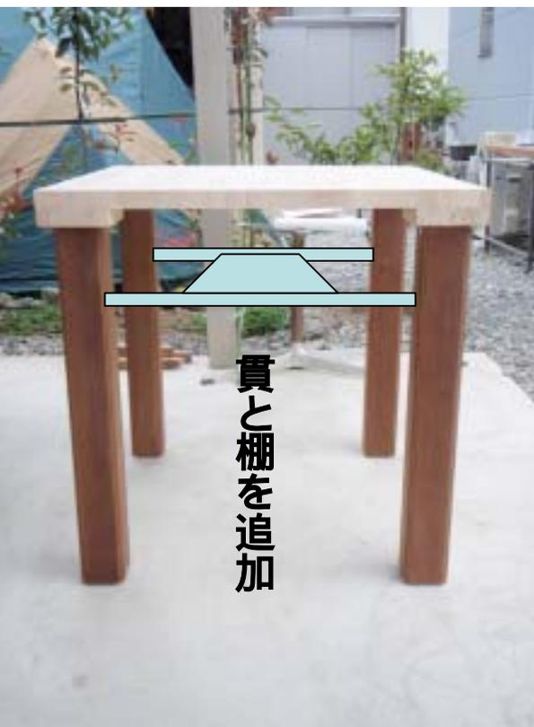
小テーブルも、カウンターテーブルと同じ材料だが、問題は、脚固定治具でネジ留めするだけでは、天板の反りのため脚が内股状になること(30mm厚の集成材は反らないと思っていたのに)。その対策として、下記を施した。
